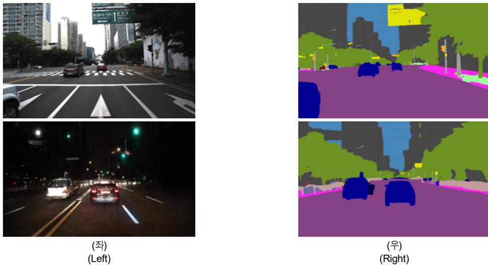
그림 4. (좌) Panoptic-DeepLab<sup>[5]</sup>에 입력된 원본 이미지, (우) 최종적으로 얻은 영상 분할 정보 이미지
