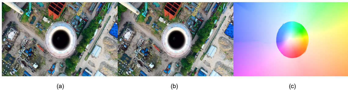
그림 3. 드론의 고도 상승 시 광학 흐름 (a) 13 th 프레임 (b) 14 th 프레임 (c) 수렴하는 형태의 광학 흐름 Fig. 3. Optical flow when the drone rise in altitude (a) 13 th frame (b) 14 th frame (c) Converging optical flow
